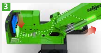
Nahezu konstante Kraft über den gesamten Zylinderweg unterstützt den nächsten Hebevorgang
